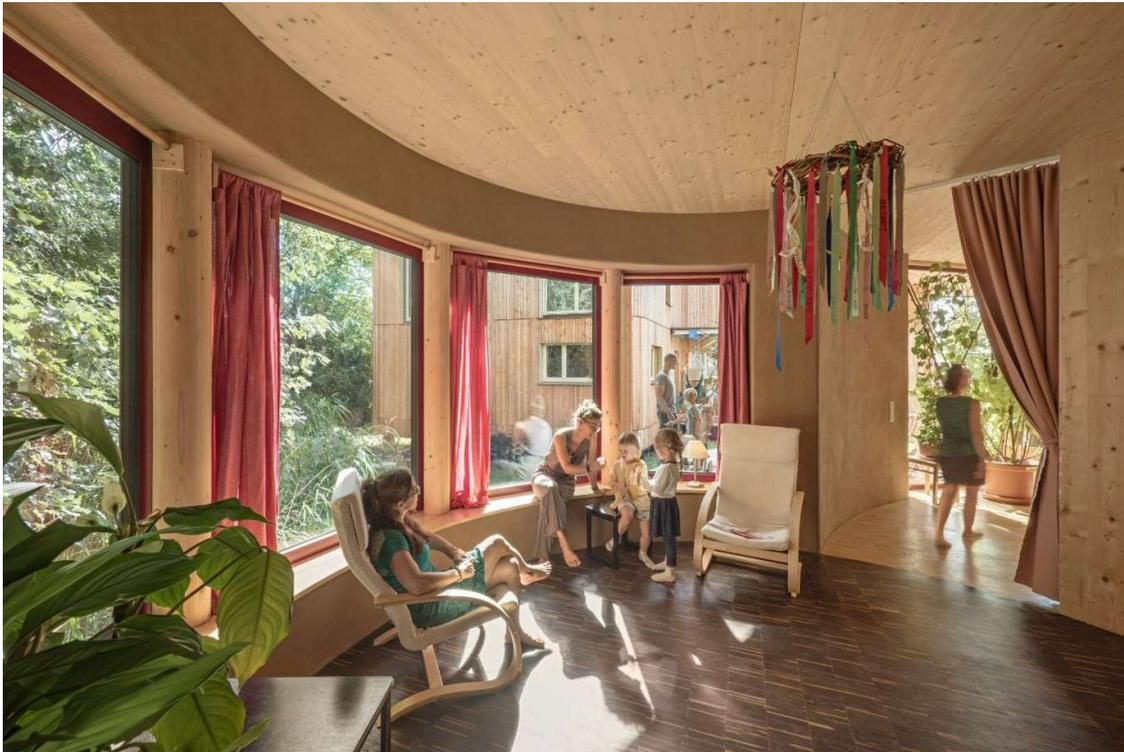
Die Häuser der Auenweide sind in Holzrahmenbauweise gebaut, mit Stroh gedämmt und innen mit Lehm verkleidet. Und das für einen Quadratmeter Preis von nur neun Euro. Bild: Hertha Hurnaus
